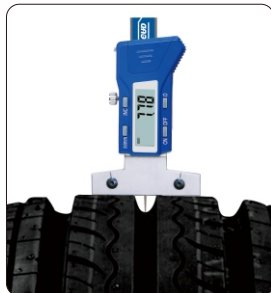
测量轮胎胎纹深度
